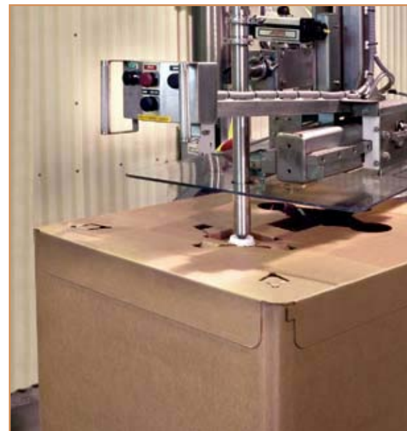
ReadyFill™ совместим с автоматическим оборудованием часто используемым с другой тарой - бочками и пластиковыми кубами в обрешетке.
